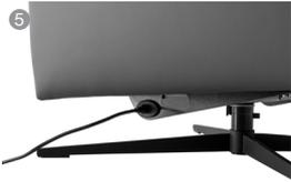
Nun stecken Sie das Netzkabel (Kabel A) in eine stromführende Steckdose (Abbildung 6). Platzieren Sie das Netzteil möglichst wandnah. Bitte achten Sie darauf, dass das Netzkabel so verlegt wurde, dass keine Stolperfallen entstehen können.
